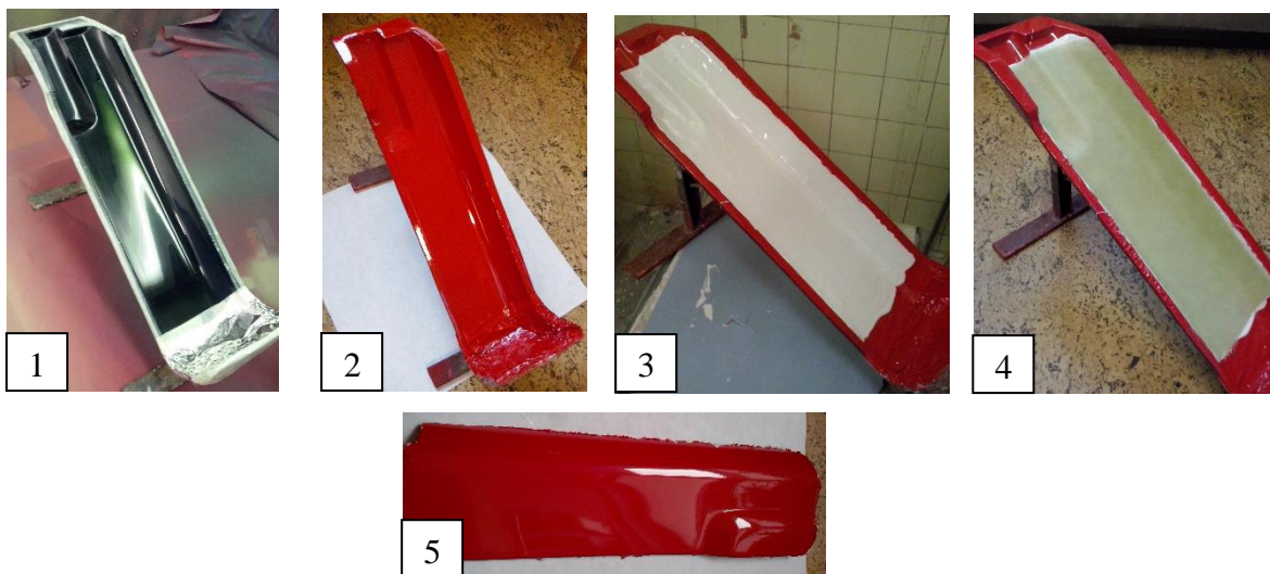
Obr. č. 5: 1) Forma + separátor, 2) nastříkaný 2K-PUR email, 3) aplikace gelcoatu, 4) laminace se sklo vyztuží, 5) produkt z formy neořezaný
