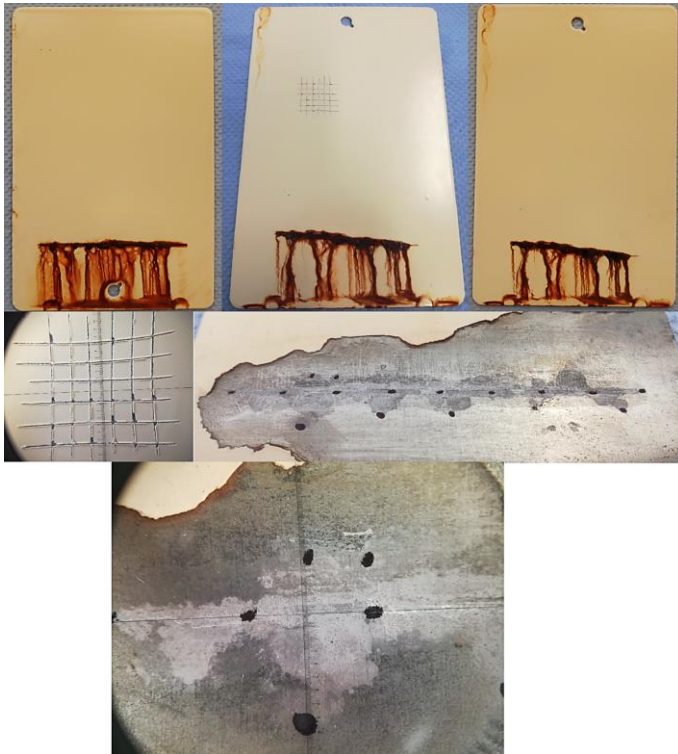
Obr. 4 Fotografie vzorků po 480 h testu neutrální solné mlhy dle ČSN EN ISO 9227 NSS s následným mřížkovým testem dle ČSN EN ISO 2409. Dále fotografie koroze v řezu po odstranění korozních zplodin mořením.
