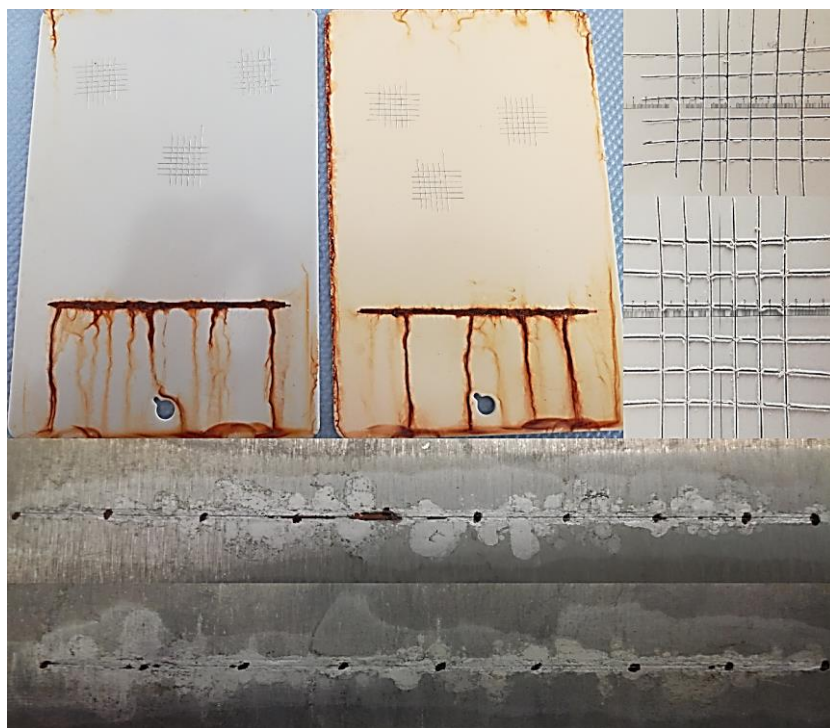
Obr. 2 Fotografie vzorků po 240 h testu neutrální solné mlhy dle ČSN EN ISO 9227 NSS s následným mřížkovým testem dle ČSN EN ISO 2409. Dole fotografie koroze v řezu po odstranění korozních zplodin mořením.
