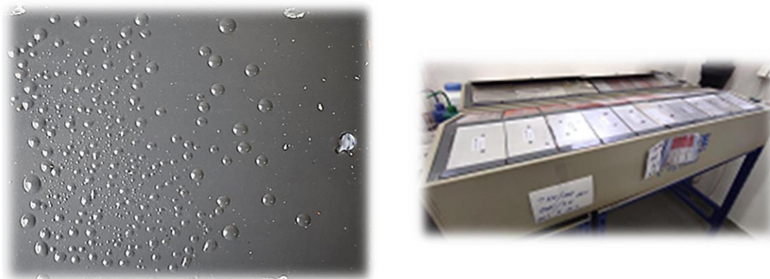
Obr. 3: Vznik puchýřků ve vlhkostním testu
