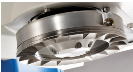
Detailní pohled na víko s lopatkami používané stanovení tokové funkce
